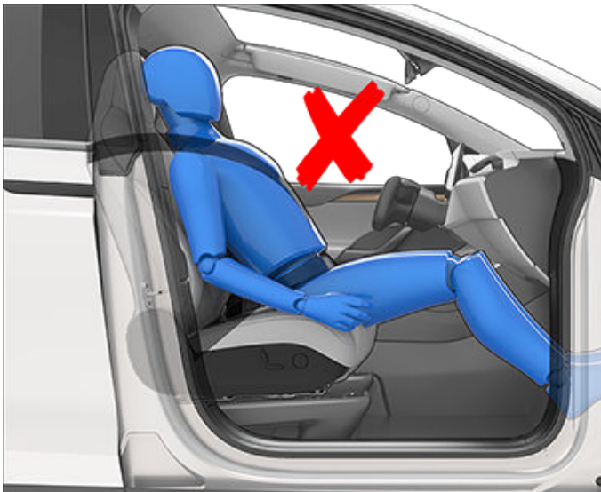
Position assise incorrecte ; le passager ne doit pas incliner le dossier pour s'allonger lorsque le véhicule est en mouvement :
